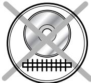
**D** Zum Vernichten von CD/DVD nur **IDEAL 2502 - 6 mm, 2602 - 4 und 6 mm und 3102 Streifenschnitt** Maschinen verwenden (Bei Cross/Cut Maschinen **Splintergefahr!**).
